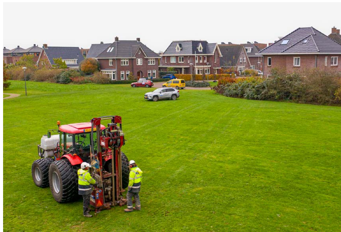
Seismisch onderzoek om meer inzicht te krijgen in de ondergrond
