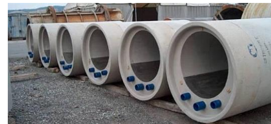
Figuur: Rioolbuizen met een warmtewisselaar. Bron: Riothermie
